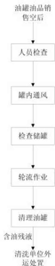
图 4 加油站油罐清理流程图
